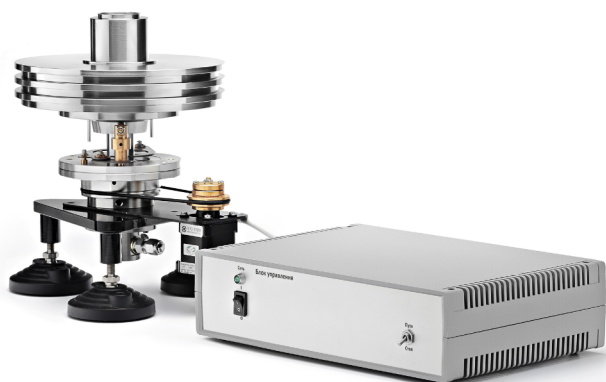
Устройство электропривода вращения поршня ИПС для облегчения работы и увеличения срока службы прибора
