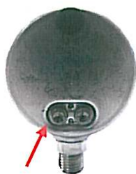
Рис. 4. Место нанесения клейма (пломбы) на калибратор давления CPG1000
