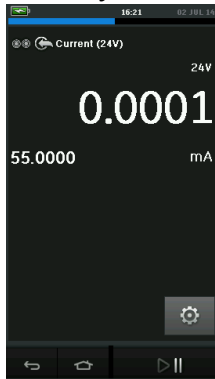
Рисунок 2-13 Измерение силы тока в канале 1 (CH1). Диапазон \pm 55 мА
