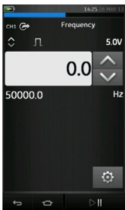
Рисунок 2-18. Пример В, частота генерации CH1 (диапазон 0—50 кГц)
