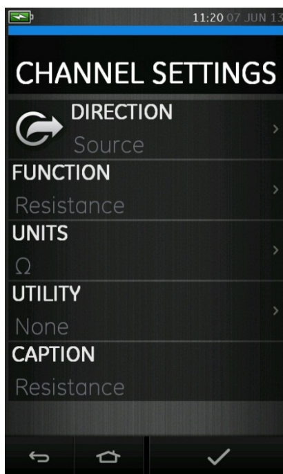
Рисунок 2-3. Меню Channel Settings (Настройки каналов)
