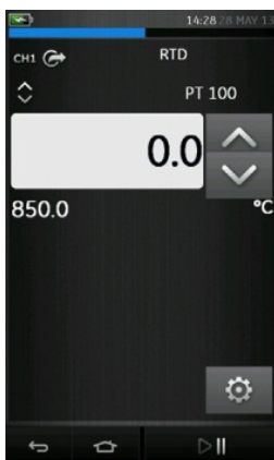
Рисунок 2-20. PT100 РДТ, генерация CH1 4-проводным РДТ (диапазон от -200 до 850 °C)
