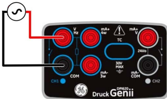
Рисунок 2-12. Измерение напряжения перемен. тока или мВ перемен. тока на CH1. Диапазон \pm 20 среднеквадратических вольт
